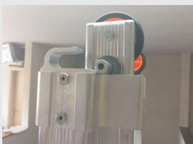
Sem levantar o lance superior puxe-o de tal forma a abrir a escada completamente. O sistema de travamento será feito automaticamente.
